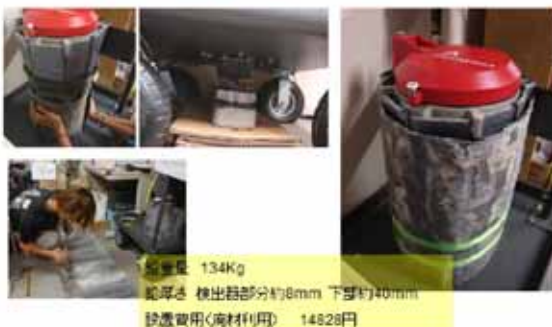
鉛遮蔽体の追加によるバックグラウンドの低減
